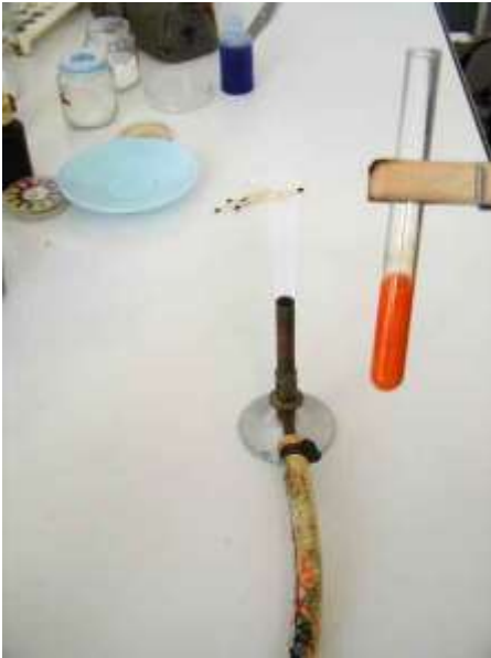
La liqueur de Fehling mélangée à une solution de glucose puis chauffée au bec Büsen, devient rouge brique
